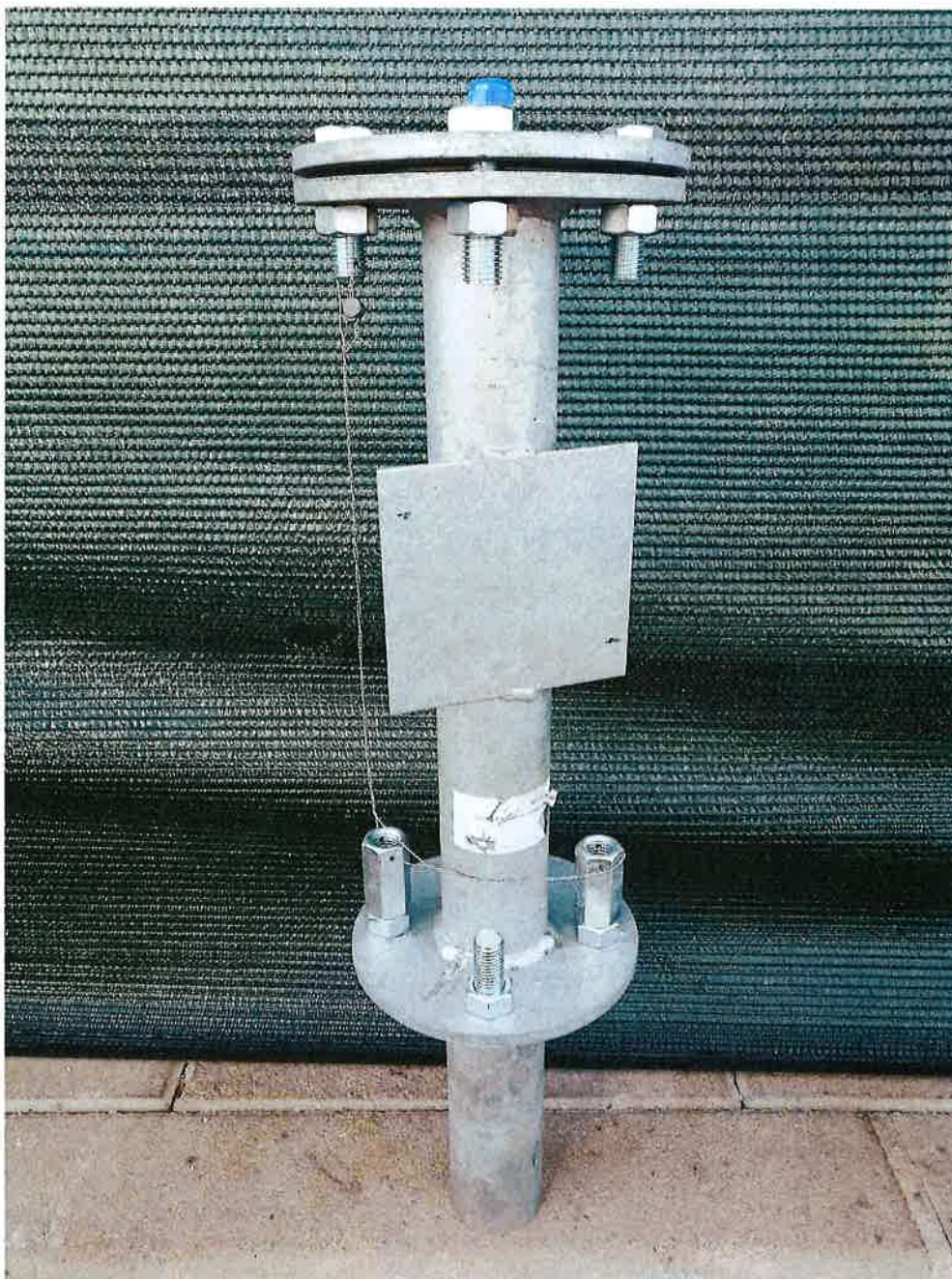
Slika 8. Zaštita i plombiranje XMT-SI-485
